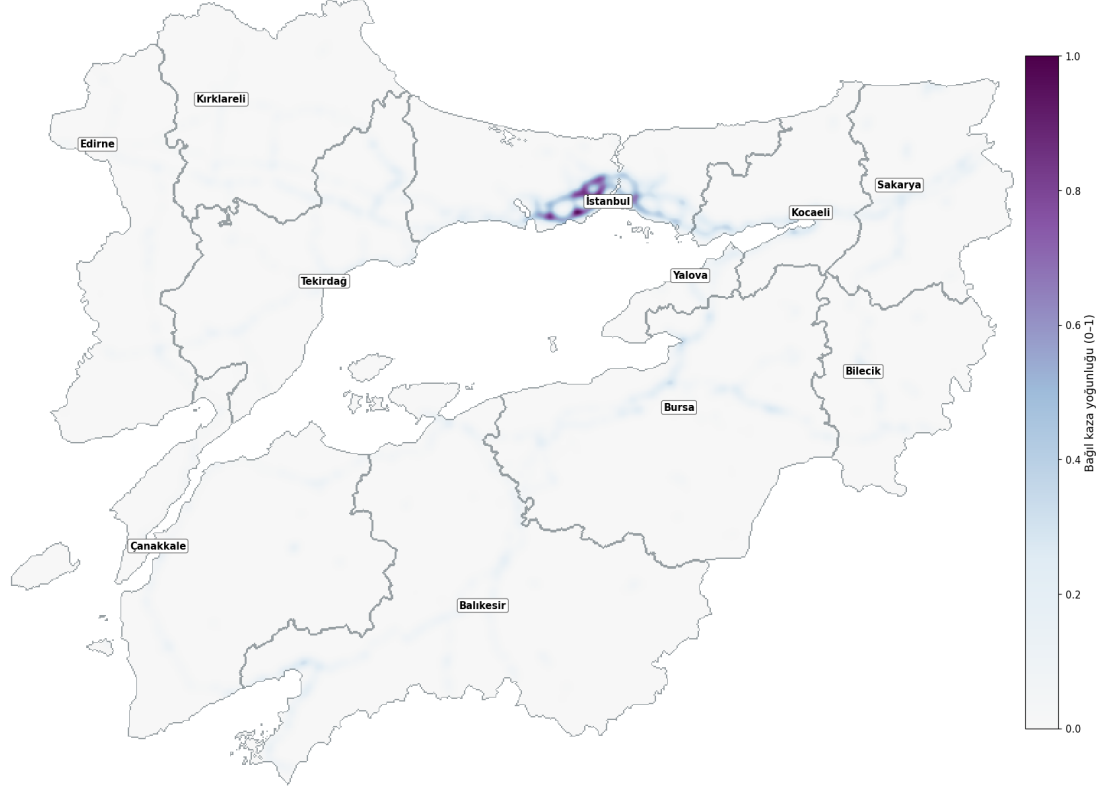
Şekil 6-3 Ağır taşıt koridorlarında kaza yoğunluğu (2020–2024). Otoyol, devlet yolu, il yolu ve bağlantı yollarındaki 45.365 ölümlü-yaralanmalı kaza; şiddet ağırlıklı (ölü + 0,1 × yaralı) ve yıl-normalize çekirdek yoğunluğu; 500 m grid (EPSG:5637).
